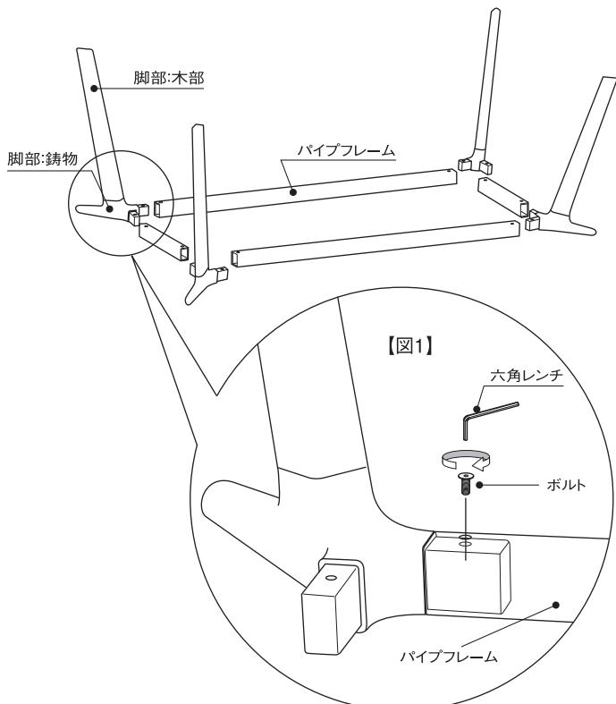
2. 脚部とフレームが一体になりましたら、床に当てないように起こします。脚部を起こしましたら、再度ボルトの増し締めを行い、ゆるみがないか確認してください。
