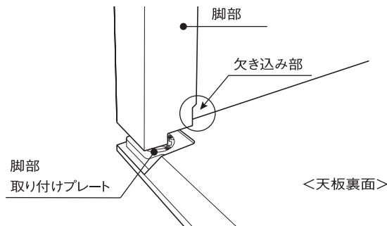
4. 脚部を矢印(a)の方向(内側)へ押す付け、脚部の位置を調整しながらボルトを付属の六角レンチで締め付けます。
