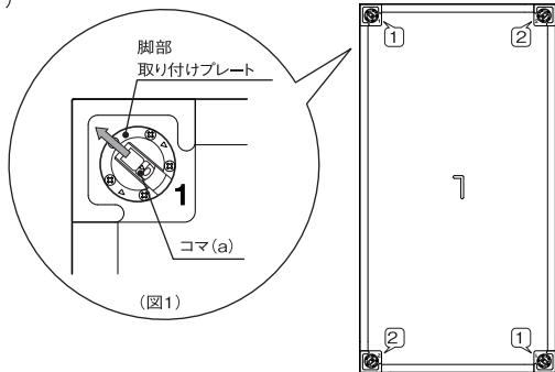
3. 脚部の欠き込み部を天板の内側へ向けてプレートへ差し込みます。
